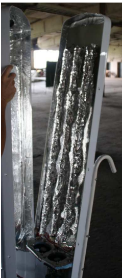
Abb.10: Versuchsreihe: ohne UVC; Umwicklung der Brenner mit Alufolie
