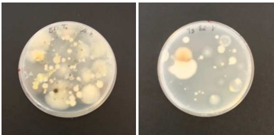
Abb.2: Keimspektren der Luft der Virobuster-Versuchsreihe; links: t 0 (Anfangskeimbelastung), rechts: t 2 (Keimbelastung nach 6-stündigem Betrieb)
