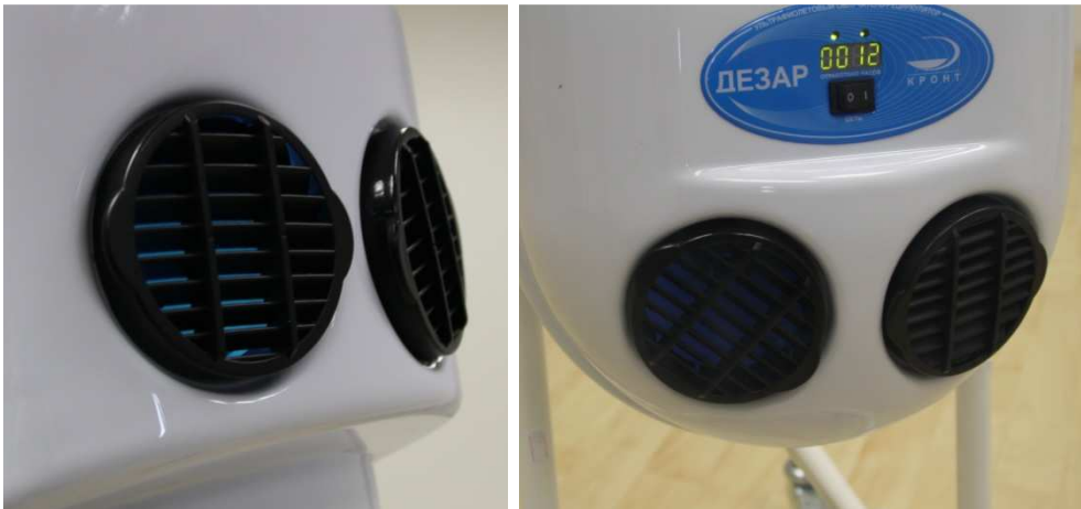
Abb.8: Halb-offene UV-Strahlungsquelle des Desar Kront Gerätes
