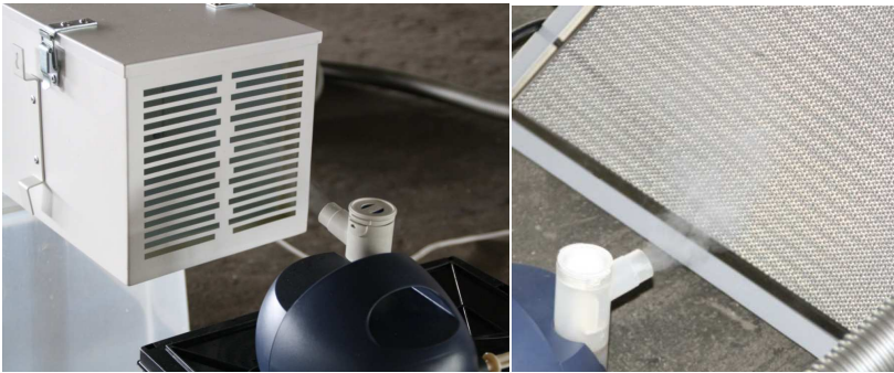
Abb.9: Vernebelung von A.niger ; links: Airlife-Gerät; rechts: Virobuster
