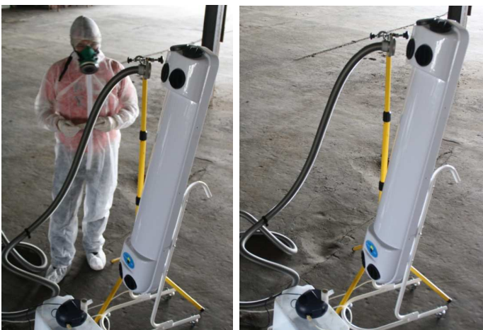
Abb.11: Experimenteller Aufbau bei der Vernebelung von A.niger in das Desar Kront Gerät
